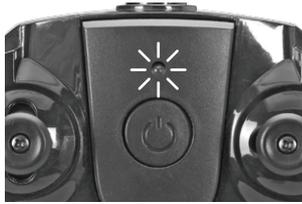
①コントローラーの電源スイッチを押してONにすると電源ランプが点滅します。
