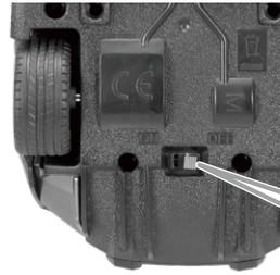
②本体裏面の電源スイッチをONにします。コントローラーの電源ランプが消灯したらペアリング完了です。
